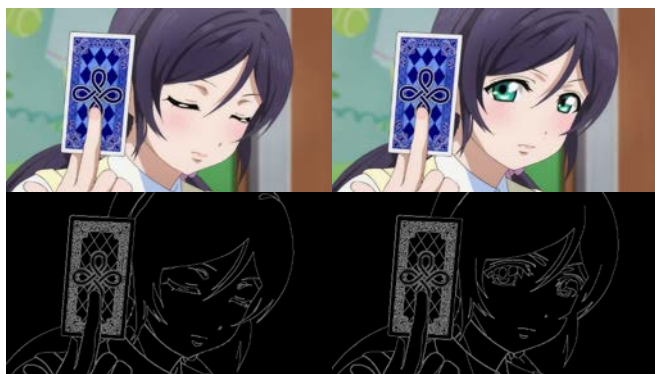
(a) 目が閉じているシーン (b) 目が開いているシーン エッジピクセル数: 14226 エッジピクセル数: 15442
